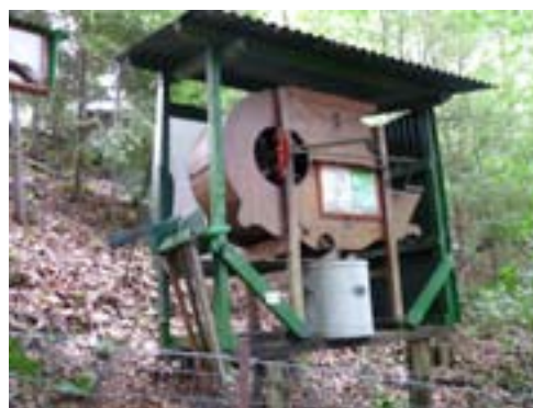
Tarare Machine servant à cribler le grain après vannage du blé
